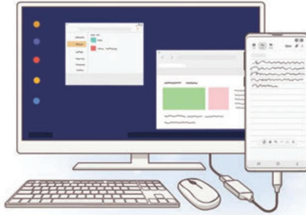
HDMI 어댑터(USB Type-C to HDMI)나 DeX Pad(데스 패드)를 이용해 스마트폰을 외부 디스플레이에 연결할 수 있습니다. 여기에서는 HDMI 어댑터를 이용하는 방법을 예로 들어 설명합니다.
