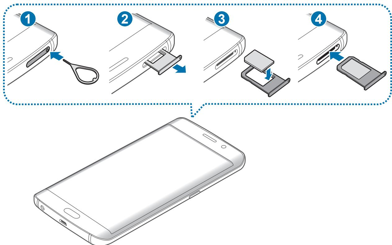
**1** Τοποθετήστε το εξάρτημα εξαγωγής στην οπή της υποδοχής της κάρτας SIM για να ανοίξει η υποδοχή.
